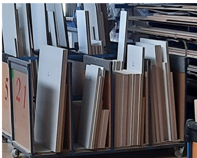
Obr. 6: Příklad mezioperačního uložení materiálu citlivého na poškrábání nečistotami z výroby
