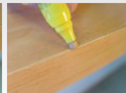
Oprava poškozené hrany
